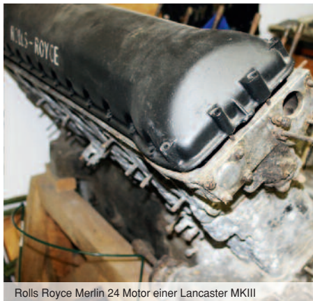
Rolls Royce Merlin 24 Motor einer Lancaster MKIII
